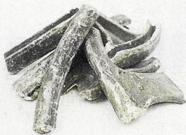
平林金属が廃自動車のハンドルから回収したマグネシウム
