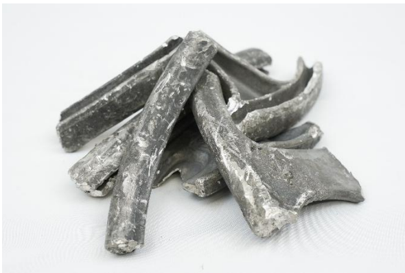
平林金属で破碎・選別された再生マグネシウム原料
