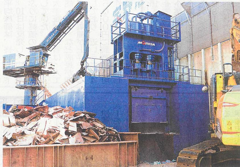
港工場に導入した鉄スクラップの大型切断機
