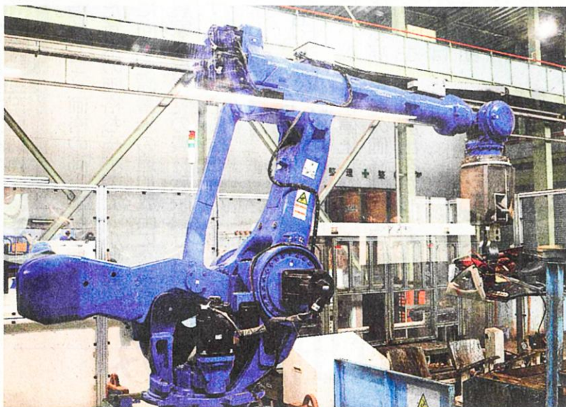
平林金属が本格運用している室外機の解体ロボット
