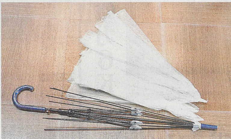
手作業によりビニールシートと鉄などの骨組みが分別された傘
