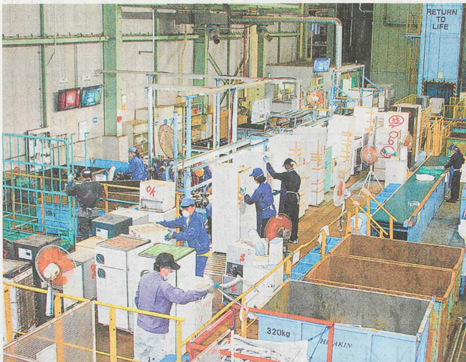
冷蔵庫のリサイクルライン。手作業でゴムパッキンなどを取り外した後、自動ラインで破碎、資源を選別している
