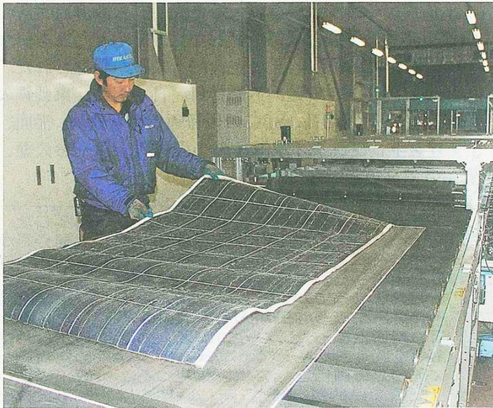
平林金属が新設した実験ライン。手前は分離した太陽光フィルム（上）とガラス
