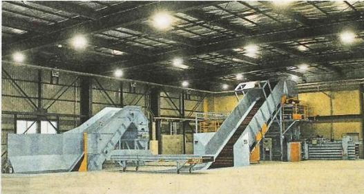
古紙加工を手掛ける専用棟に導入した選別機(左)と圧縮梱包機
