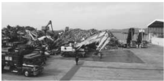
正門と放射能探知機を通れば目の前に広がるストックヤードと重機、大型トレーラー。左手奥にギロンチン、南星機械のタワーローダーが見える。
