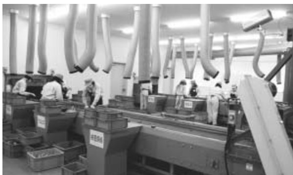
磁選・非鉄選別ライン棟に接続するピッキングルーム(2階)。手前が非鉄選別ライン。奥が鉄スクラップライン。回収箱に一定量が溜まれば、品種ごとに決められたシューターに投入する。一階・専用箱容器で貯蔵する仕組み。天井から下がっているのは個人用冷気クーラー。
