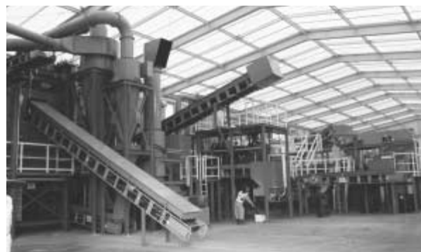
リサイクルステージ玉島はダストからのメタル回収やダストリサイクルも高度に機械化を進めている。(株)かやまが、ASRは「地上の鉱山」、「資源の宝庫」だとの理念のもとに製造、設計したマシン。社外廃棄物排出ゼロを目指すヒラキンのゼロエミッション工場。
