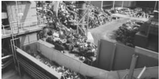
アーステクニカ製の1600馬力・本体と、600馬力・プレシュレッダーがコンベヤーで直列している。右側が400馬力予備・プレシュレッダー。
