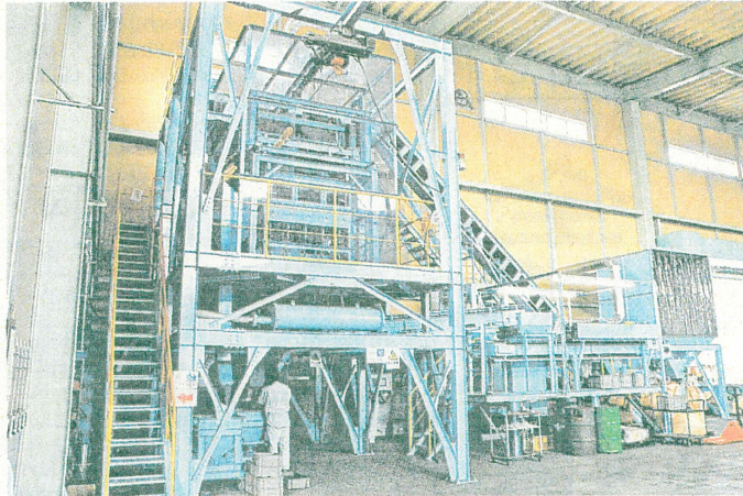
平林金属が西大寺工場に導入、本格稼働を始めたアルミの選別装置
